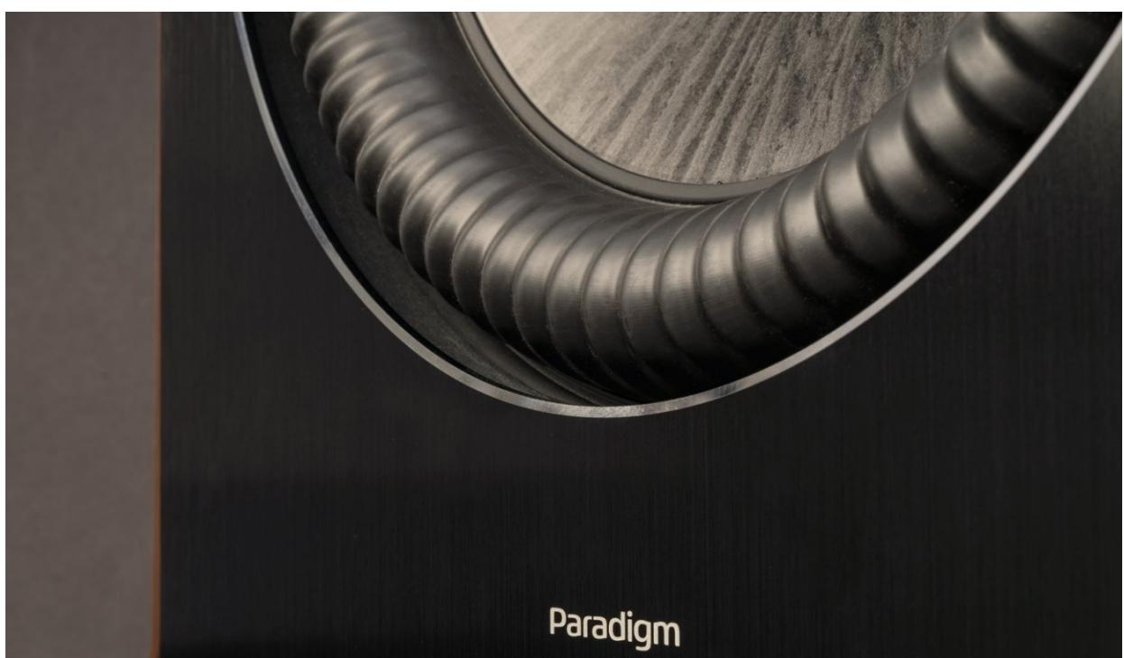
L'originalité (et la force) de cette architecture, dite à "montage vertical", réside dans son utilisation de la profondeur et non de la largeur. Le haut-parleur est monté au sein d'un saladier supérieur, entièrement moulé en aluminium, accueillant la membrane (avec sa suspension) et le premier spider, et d'un saladier arrière à fond plat, lui-aussi en aluminium moulé, disposant d'un second spider.
