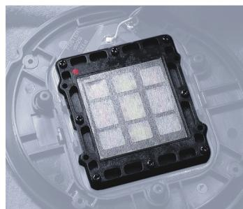
RP signifie « à phase régulée » (Regulated phase), une technologie de transducteurs qui a permis à Fostex de déposer plus de 20 brevets mondiaux. Celle-ci a été appliquée à des microphones, des casques et des haut-parleurs, pour des usages et professionnels et commerciaux dans le monde entier.
