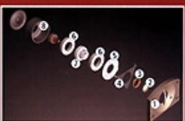
Vue en coupe du bâtiel: 1 - Plaque support en aluminium avec pince de phase verticale, 2 - Dôme de 2,5 cm en aluminium anodisé et 3 - Bâtiel mobile baignant dans le fluide pour un meilleur amortissement et un refroidissement assuré. 4 - Support isolant en étoile support, 5 - Plaques de champ, 6 - Double alésage annulaire en super-acrylique, 7 - Noyau central, 8 - Chambre aménagée à amortissement progressif et par dissipateur thermique pour
